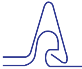
Figure 8. Compatible Panel Seams – PV Cube KLOC Mini
